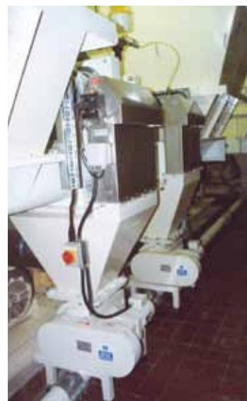
Blow-through rotary valve and pneumatic conveying system Durchblassechleuse und pneumatische Förderung Trémie d'écluse rotative pour transport pneumatique Sfilato rotocella con trasporto pneumatico
