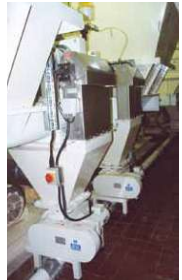
Blow-through rotary valve and pneumatic conveying system Durchblasseleuse und pneumatische Förderung Trémie d'écluse rotative pour transport pneumatique Sfilato rotocella con trasporto pneumatico
