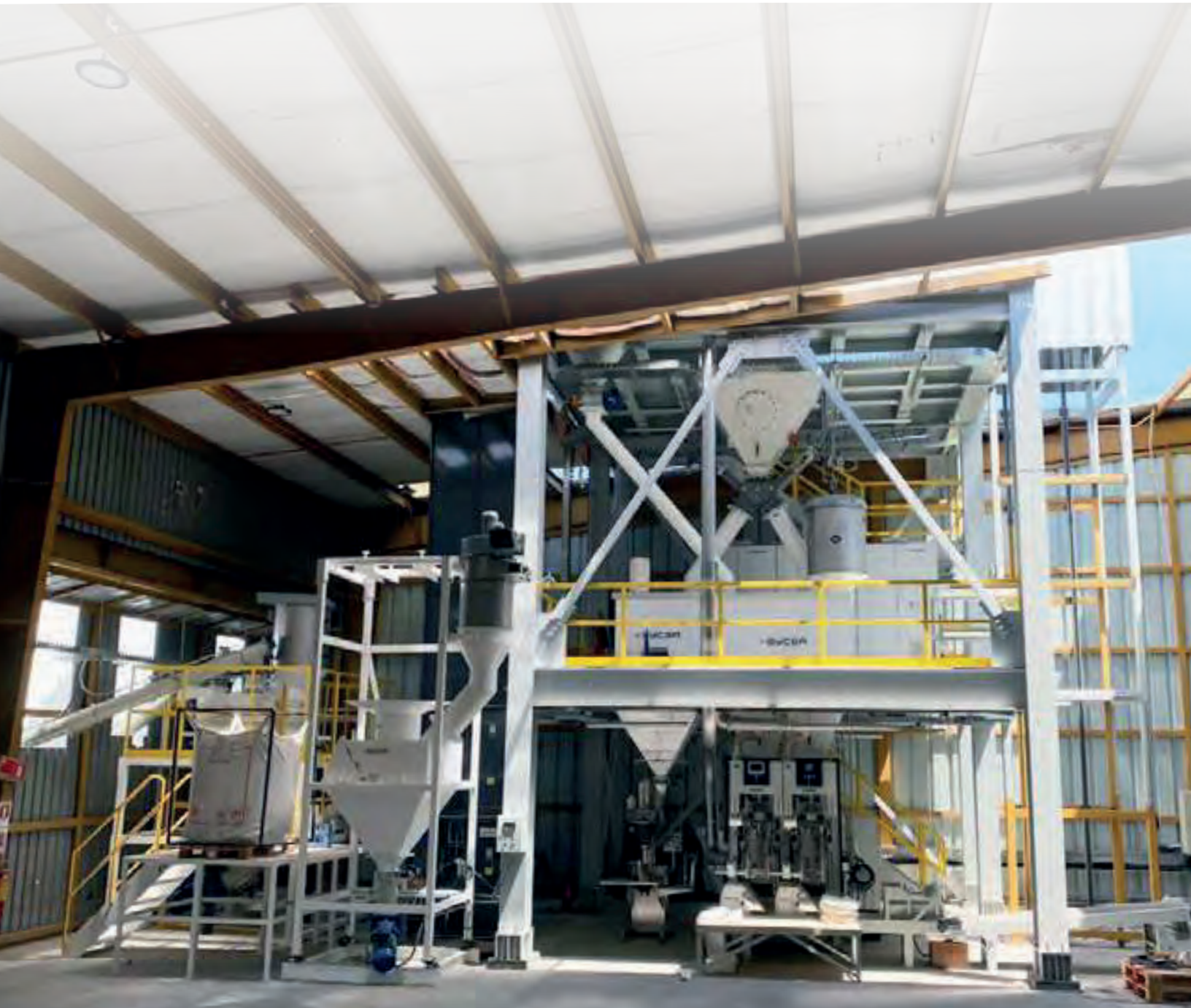
Equipo para dosificación, pesaje, mezclado y ensacado de productos para la industria de la construcción
