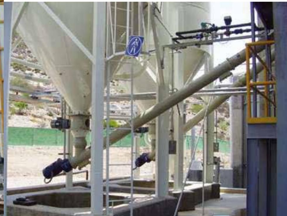
Silo de almacenamiento conectado a tornillos helicoidales para transporte mecánico
